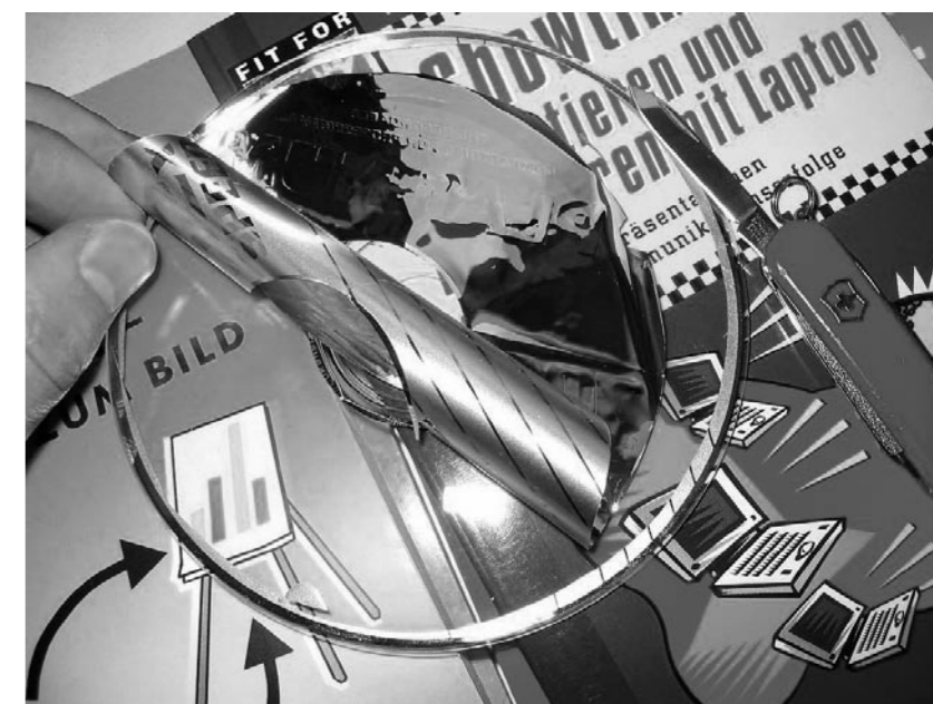
■ So sieht es aus, wenn die Datenschicht vom Rohling abgelöst wird. Der transparente Polycarbonat-Rohling wird von unten vom Laserstrahl durchleuchtet, der in der Datenschicht die Pits und Lands unterscheidet/liest. Foto: Michael Gasperl
